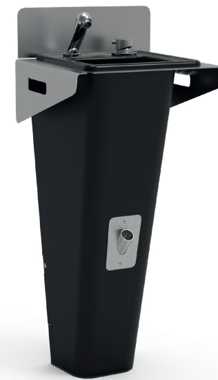
Fontana | wandmodel waszuil vervaardigd uit roestvrijstaal met kunststof wasbak (zwart). Onderkappen van RVS zwart gepoedercoated (RAL 9011). Wasbak voorzien van mengraan, handdouche doucheslang (250 cm), afvoer, sifon en inlaatstuk voor afvoer mobiele wasbak. Bestemd voor combinatie met wasbak op statief (art. 5509, 5506 en 5512) en met ziekenhuiswasbak 5669.
